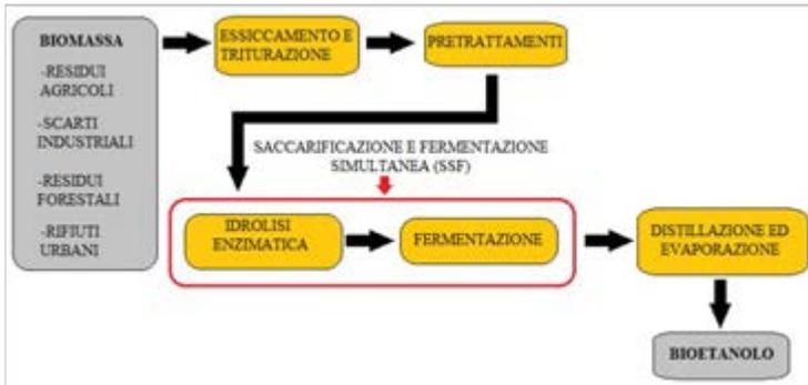
Fig. 4.2: Diagramma di flusso del processo di produzione di bioetanolo di II generazione
