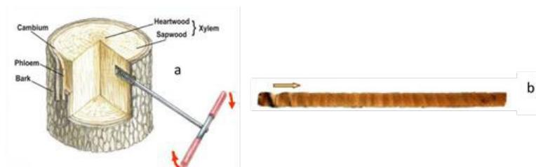
Fig.2.5: a) schema di infissione per rotazione del campionatore all'interno del tronco (Trapp et al., 2012); b) campione di tronco estratto dal succhiello
